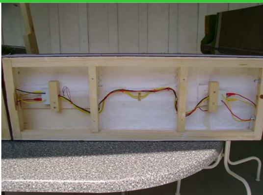
Modulverdrahtung mit Lötleiste für Lichtleitung. Steckrichtung immer waagrecht
