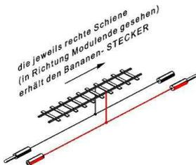
*Interne Verbindungen von Modulgruppen können auch abweichend der Norm verdrahtet werden, an den Enden der Modulgruppen müssen jedoch der Norm entsprechen ausgeführt werden.
