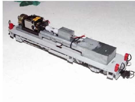
Rahmen für den Einbau vorbereitet
