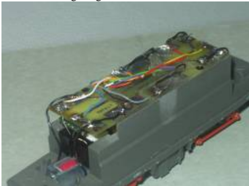
Die fertig montierte und eingelötete Platine Achtung Anschlüsse NICHT auskreuzen
