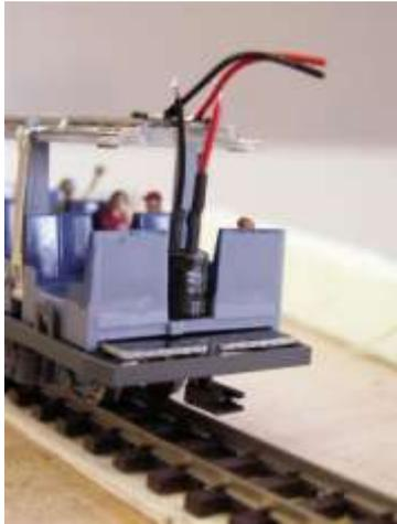
Der Wendezug-Steuerwagen bietet mit dem Beleuchtungssatz Lil038945 und den beiliegenden Kontakten die Möglichkeit der einfachen Beleuchtung. Der Kondensator passt leider nicht in die Dachwölbung des Wagens und muss daher in den Fahrgastraum. Allerdings ist das Kabel des Kondensators etwas zu lang und sollte eingekürzt werden. Der Kondensator lässt sich leicht im Mittelgang zwischen linker und rechter Sitzreihe festklemmen.
