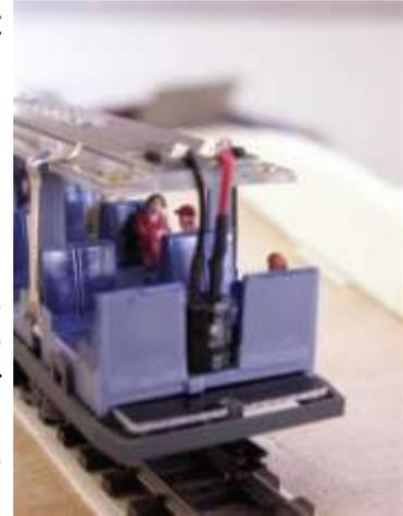
Wenn man den Wagen ohnehin zerlegt hat, bietet sich auch die Gelegenheit zur Digitalisierung. Dazu kann man einfach einen kleinen Decoder mit NEM651-Schnittstelle in die vorhandene Schnittstelle stecken, riskiert dabei aber, dass nach dem Zusammenbau Bodengruppe des Wagens und Inneneinrichtung auseinander gedrückt werden.
