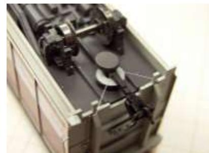
Nach dem Eindrücken des Kupplungsstopfens die Spannung der beiden seitlichen Federstahldrähte einjustieren, so dass die Kupplung mittig steht.
