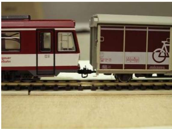
Wer einen längeren Kupplungsabstand (z. B. wegen kleiner Bogenhalbmesser auf der Anlage) wünscht, muss die Bohrung für das 1,6-mm-Loch anders setzen oder die lange MVT-Scharfenberg-Kupplung verwenden.
