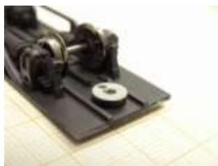
Die Scharfenbergkupplung wird wie beim 5090 etwas aufgerieben, von der Fa. Halling benötigt man als Ersatzteil zwei Kupplungsstopfen für den 5090. Die Führung der Kupplung muss so weit aufgerieben werden, dass sie sich auf dem Kupplungsstopfen leicht drehen lässt. Ist die Bohrung aufgerieben, kann schon wieder mit dem Zusammenbau begonnen werden.
