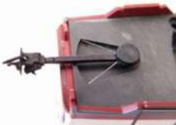
Der Abstand zwischen zwei 5090 vergrößert sich bei Einsatz der Kupplung um etwa 1-2 mm gegenüber der Halling-Bügelkupplung.
