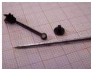
Nachdem die Bodenplatte vor uns liegt, wird die bisherige Kupplung entfernt. Den Stopfen benötigen wir aber für den Einbau der Scharfenberg-Kupplung wieder. Danach wird der überstehende Teil der Kupplungsführung plan mit der Unterkante der Bodenplatte abgeschnitten. In die Kupplungen wird die Feder entsprechend der Anleitung von Modellbau Veit eingeklebt. Beim Abwinkeln der Federdrähte darauf achten, dass diese in die Führung der alten Kupplung greifen sollen.
