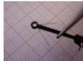
Nach dem Eindrücken des Kupplungsstopfens ausprobieren, ob die Kupplung immer wieder in Mittelstellung zurückfedert. Ansonsten den Stopfen wieder etwas lockern. Beim aktuellen Umbau war eine zusätzliche Führung durch einen Bügel an der 5090-Front nicht nötig, die Kupplung war sauber geführt.
