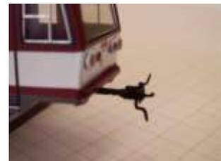
Wer einen geringeren (und vorbildgerechteren) Kupplungsabstand wünscht, muss direkt hinter der bisherigen Kupplungsaufnahme ein 1,6-mm-Loch bohren und dort den Kupplungsstopfen einstecken. Im
