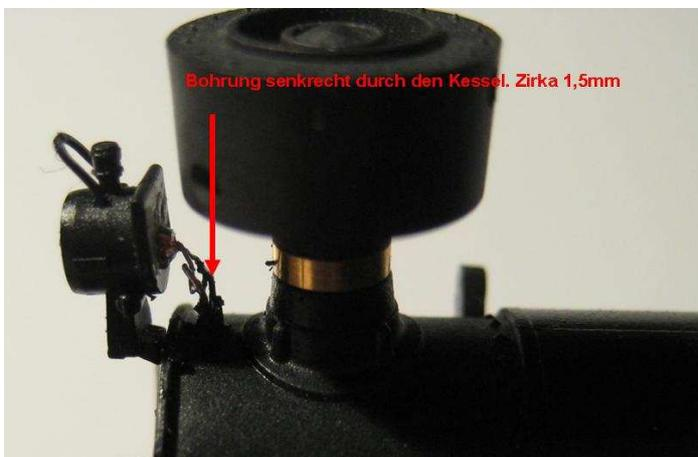
Wenn das geschafft ist, kann die Verkabelung zum Decoder erfolgen wie in der Anleitung der 399 beschrieben (möglichst dünne und flexible Decoderlitzen verwenden), Kabelenden am Kessel oben heraus schauen lassen und die Maschine wieder zusammenbauen. Abschließend werden die Drahtenden der Lampe sowie die überstehenden Decoderlitzen auf jeweils zirka 2 mm gekürzt, das Lampegehäuse
