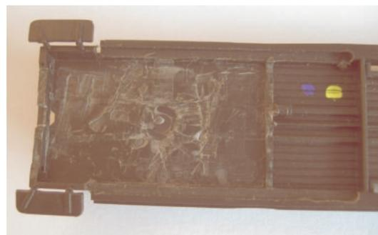
In die nun plane Öffnung wird eine Polystyrolplatte 1mm/32,5x18,7mm eingeklebt, die dann als neue Drehgestellaufnahme dient.
