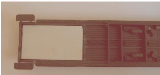
Nach dem Trocknen werden noch die neuen Bohrungen zur Aufnahme der Drehgestellstifte 22,5mm von der Grundplattenkante entfernt, gebohrt und das weiße Polystyrol schwarz eingefärbt (Achtung, nicht im Bereich des Drehzapfens!).
