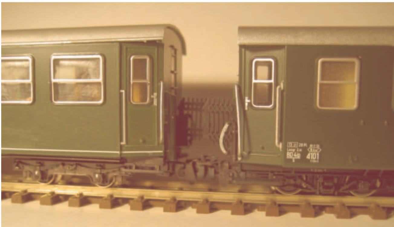
Am Foto deutlich erkennbar die geänderten Drehzapfenabstände, die anderen Drehgestelle und die kleineren Räder. Die Fahrzeughöhe bleibt bei diesem Umbau gleich, was den Vorbildeindruck des ‚zu kleinen Untergestelles‘ sehr gut wiedergibt.
